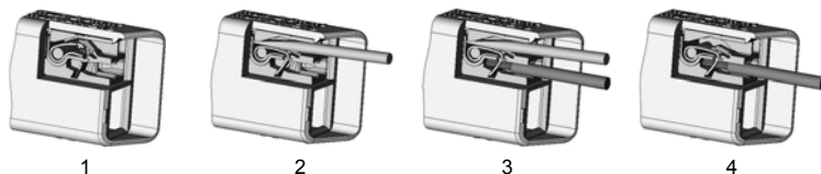
Abbildung 8-1: Raccordement du conducteur à la borne sans vis
