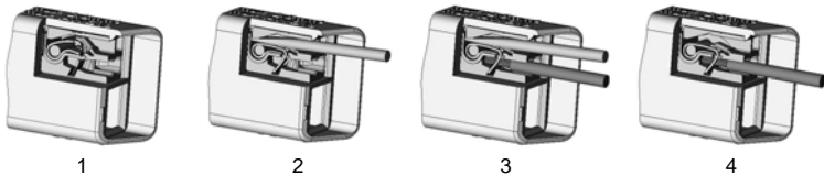
Abbildung 8-1: Leiteranschluss an der schraubenlosen Klemme
