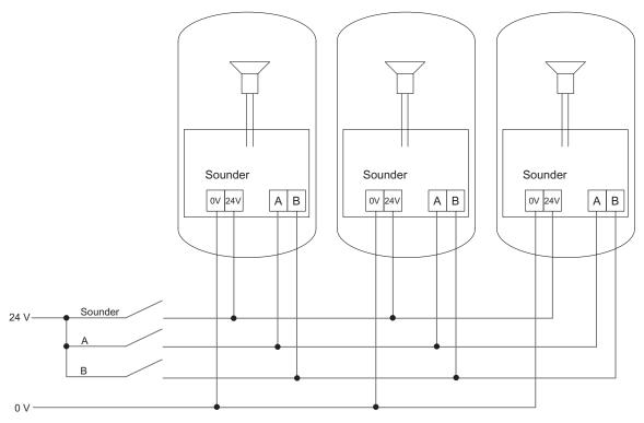
示例:多个设备组合的连线图
