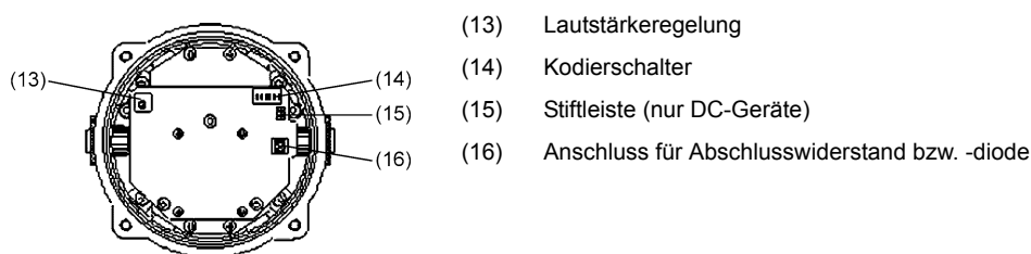
Abb. 5: Platine im druckfesten Gehäuse der Hupe Typ 8493/11-21
