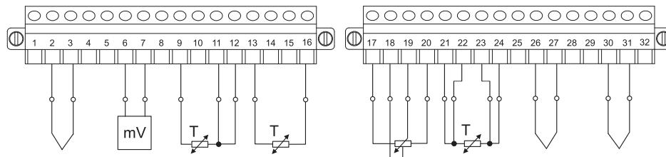
Até 8 elementos térmicos ou transmissores mV isolados com módulo de terminação interno
