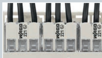
Anreihung ohne Abstandhalter für Arbeitsspannungen bis zu 275 V
