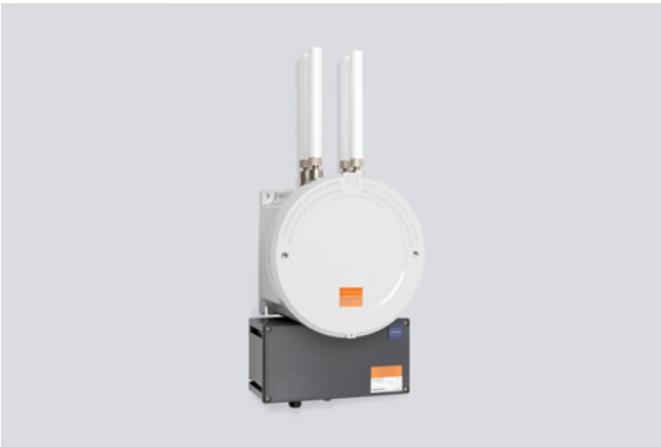
Versión basada en la caja 8265, tamaño 5, con caja de conexión Ex e de poliéster reforzado con fibra de vidrio Dispositivo integrado: Cisco ESW 6300
