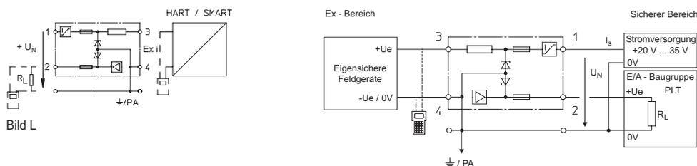
Ein-Kanal-Sicherheitsbarrieren für Messumformer
