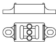
Passend für Hutschiene NS35/15, erlaubt es die Hutschiene elektrisch isoliert von der Montageplatte zu montieren.
