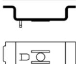
Der Adapter erlaubt die Montage einer Sicherheitsbarriere Reihe 900x auf einer Montageplatte einer Vorgängerbaureihe.
