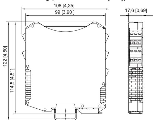
ISpac Reihen 9143, 9146, 9147, 9160, 9162, 9163, 9165, 9167, 9170, 9172, 9175, 9176, 9180, 9182, 9193, ISbus Reihe 9412 mit Schraubklemme
