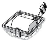
Batteriedeckel mit eingebauter Batterie. NiCd-Batterie, gasdicht; 7 Ah / 6 V
