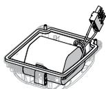
Couvercle de batterie avec batterie intégrée. Batterie NiCd, étanche au gaz ; 7 Ah / 6 V
