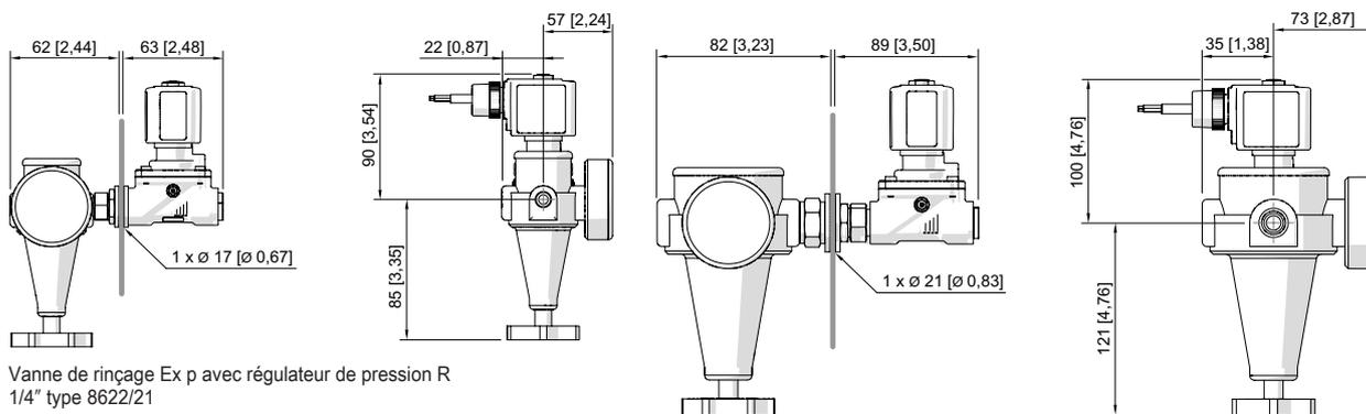
Vanne de rinçage Ex p avec régulateur de pression R 1/4" type 8622/21
