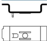
L'adaptateur permet l'installation d'une barrière de sécurité série 900x sur une plaque de montage d'une série précédente.
