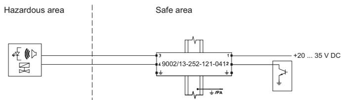
Cas d'application : sortie analogique (source de courant) pour transformateurs i/p, etc. ; circuit de terrain non mis à la terre
