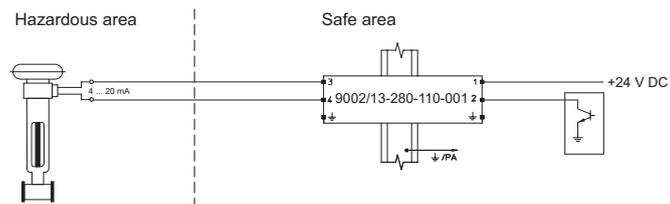
Cas d'application : transducteurs I/P 4/20 mA à 2 conducteurs et appareils de réglage - standard et HART, affichages 4/20 mA
