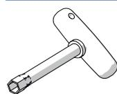
M8/ouverture de clé 13 ; pour actionner le verrouillage central
