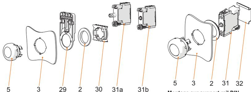
Montage en encastrement frontal avec voyant lumineux série 8010/6 et élément de contact série 8082/3
