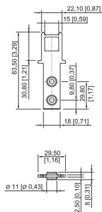
Actionneur droit pour interrupteur de sécurité
