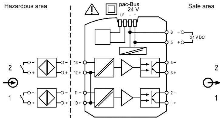
Schéma de raccordement 9270/21-14-14
