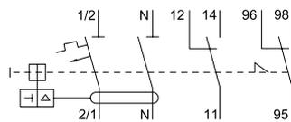
1 pôle+N, contact auxiliaire 1 contact à deux directions + contact de signal d'erreur 1 contact à deux directions
