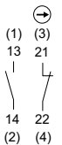
Esquema de circuito 8003/143 Contacto NC de apertura forzada/contacto NA Números entre paréntesis correspondientes a la identificación del cable
