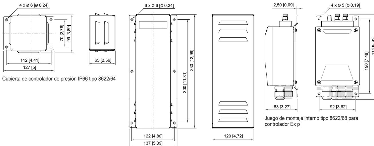
Cubierta de controlador de presión IP66 tipo 8622/64
