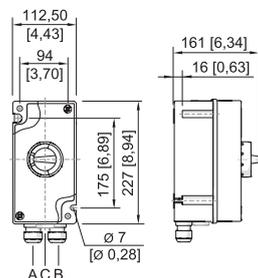
Rango de ajuste de corriente hasta 16 A, sin contacto auxiliar
