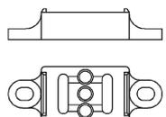
Adecuado para raíles de montaje DIN NS35/15, permite montar el raíl aislado eléctricamente de la placa de montaje.
