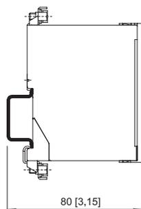
Montado en raíl de montaje DIN NS 35/15
