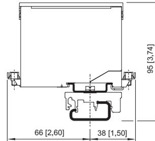
Montado en riel de montaje DIN NS 32 con adaptador y pie de sujeción de plástico moldeado
