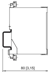
Montado en riel de montaje DIN NS 35/15
