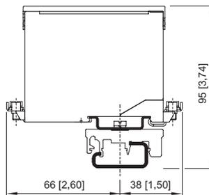
Montado en raíl de montaje DIN NS 32 con adaptador
