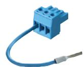
Punto de referencia externo para 1 x elemento térmico (Pt100 en conexión de dos conductores) integrado en borne enchufable (3 polos). El montaje se realiza en un dispositivo ISpac en lugar de en el borne de conexión habitual.
