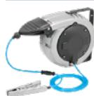
Enrollador automático con cable resistente al aceite y la gasolina de 20 m con una pinza de puesta a tierra ergonómica y robusta de acero inoxidable y un conector rápido, envoltorio de aluminio, paso para cable protegido con un tope
