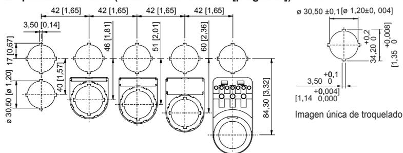
Dimensiones de montaje con/sin placa de identificación adicional
