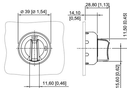
Dimensiones de montaje con/sin placa de identificación adicional
