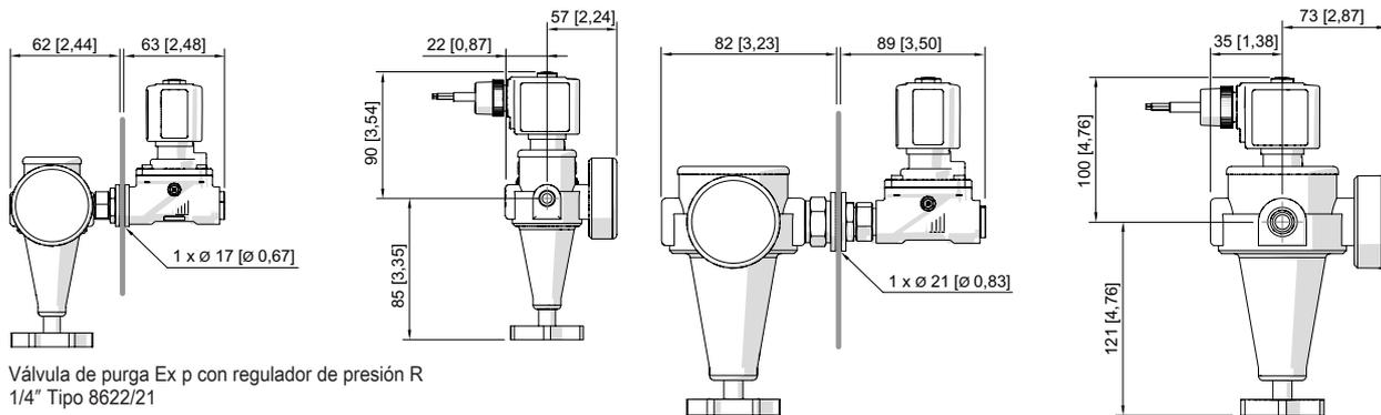
Válvula de purga Ex p con regulador de presión R 1/4" Tipo 8622/21
