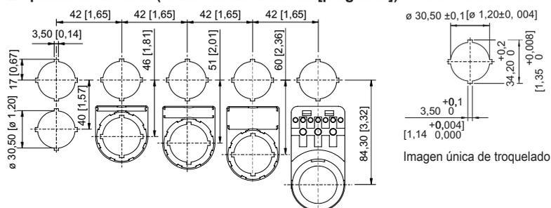
Dimensiones de montaje con/sin placa de identificación adicional
