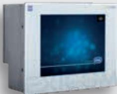
ET-436-A-TX-7309100000R-000000000000 | <b>Panel PC für Fronteinbau, 15", 1024 x 768</b> <ul style="list-style-type: none"> <li>• Format 4:3, Standard-TFT-Display</li> <li>• Zone 1, 2, 21, 22</li> <li>• 10/100Base-TX – Kupfer-Ethernet</li> <li>• ATOM E3845, 4 GB RAM, 128 GB SSD MLC</li> <li>• Analog-resistiver Touchscreen</li> <li>• Front: Polyester auf Aluminium</li> <li>• 24 VDC</li> <li>• Windows 10 IoT LTSC</li> </ul>                          | 271103   | 8.485,00  | 64 | 5     |
