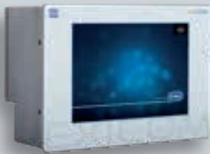
Die Panel PCs und Thin Clients der Geräteplattform EAGLE von R. STAHL empfehlen sich als Allroundtalente zur Bedienung von Maschinen und Prozessen, Tanklagern und Abfüllanlagen. Dank ihrer robusten Ausführung sind sie für den weltweiten Einsatz in Ex-Bereichen und auf Schiffen zertifiziert: beständig gegen korrosive Gase (ISA-S71.04 G3), vibrations- und schockfest, Schutzart IP66. Alle Modelle sind standardmäßig mit Touchscreens und 10- oder 15-Zoll-Display ausgestattet.
